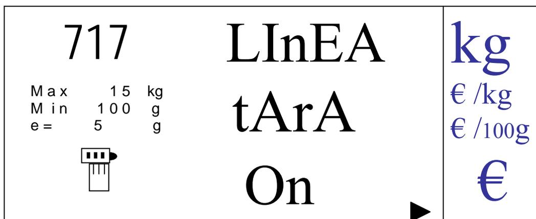
Conmutaremos entre las opciones ‘ON’ (activada (valor por defecto)) y ‘OFF’ (desactivada) mediante las teclas [V-A] y [V-B].
