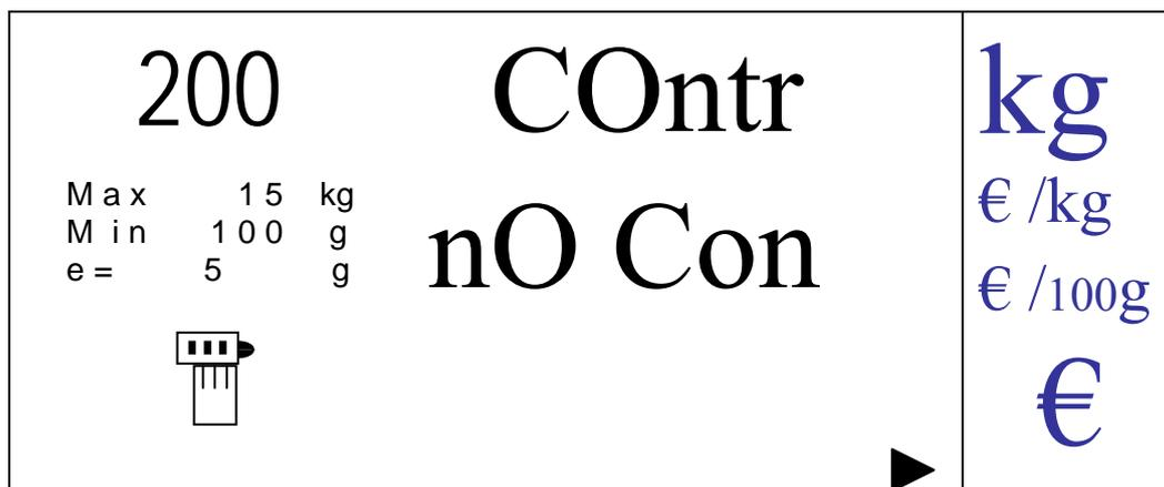
Conmutaremos entre las distintas posibilidades, “**NO CON**” (no realizar control de envasado (por defecto)), “**OPER**” (control por número de operaciones), “**IMPORT**” (control por importe) y “**PESO**” (control por peso), con las teclas [V-A] y [V-B].
