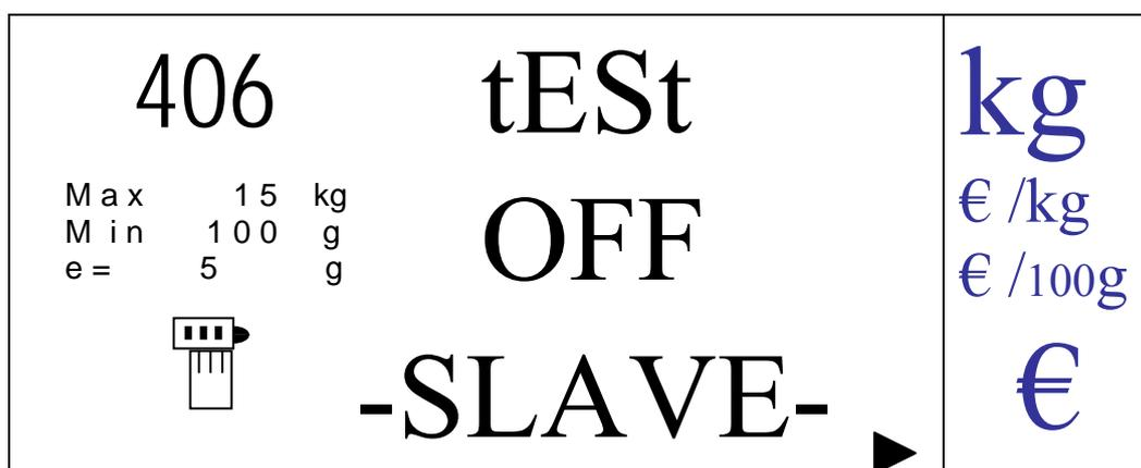
Todas las balanzas entran en un modo de test en el que se visualiza 'TEST' en el display de peso, 'ONLINE' u 'OFF', si se detecta o no actividad en el cable de comunicaciones y 'MASTER' o 'SLAVE' si la balanza tiene o no el máster de las comunicaciones.
