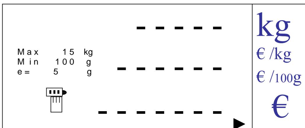
Para pasar inmediatamente a realizar el cero absorbiendo el peso que hubiera sobre el plato (siempre menor que el 2% del fondo de escala de la balanza).
