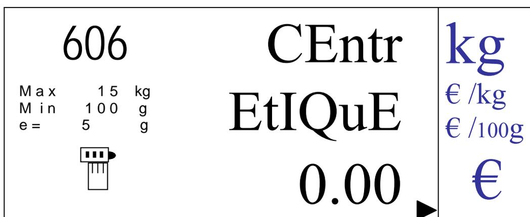
Conmutaremos el valor en saltos de 0.25 con las teclas [V-A] y [V-B]. Este valor muestra el desplazamiento vertical en milímetros que se aplicará en la etiqueta. Varía entre -4.00 y +4.00mm.
