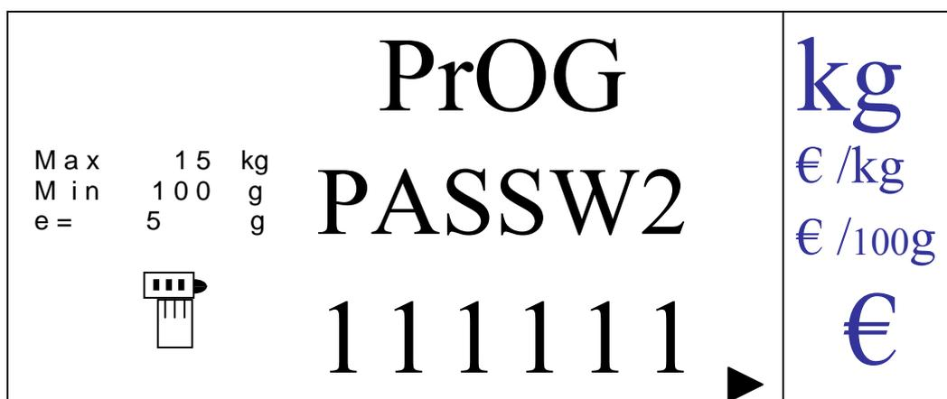
Introduciremos un valor numérico entre '0' y '999999' mediante el teclado numérico. El valor por defecto será '111111'.
