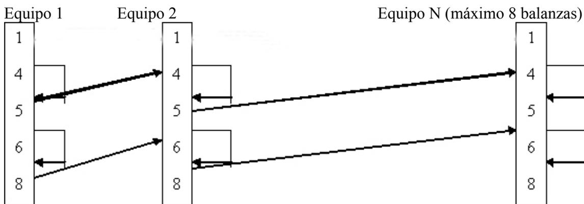
NOTA: El cable a utilizar para la interconexión RS-485 será un cable del tipo par trenzado y apantallado 2 x 1 x 0,34 y con una longitud máxima de 100 metros. El único tipo de topología de red soportado es el de tipología tipo bus. Para que todas las balanzas estén referidas al mismo potencial, todos los pines 1 deberán estar unidos a través de la malla.
